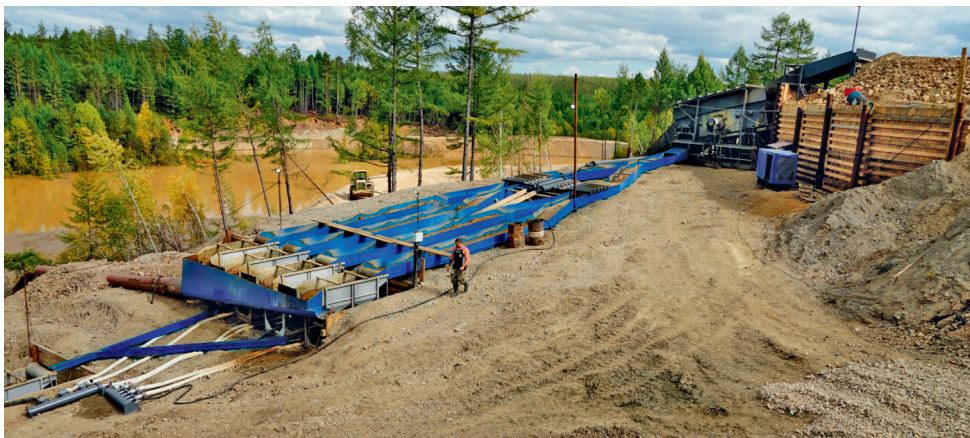
Рис. 1. Промывочно-сортировочный комплекс ПСК-62 на базе грохота инерционного тяжелого ГИТ-62
