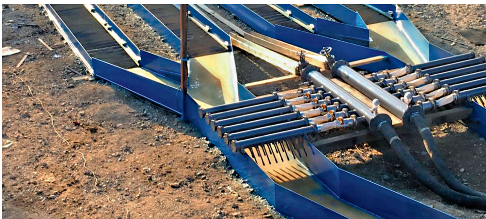
Рис. 2. Кавитатор на сопряжении пульповода с самими шлюзами предназначен для торможения потока пульпы встречными струями воды, которая поступает из общей системы подачи комплекса
